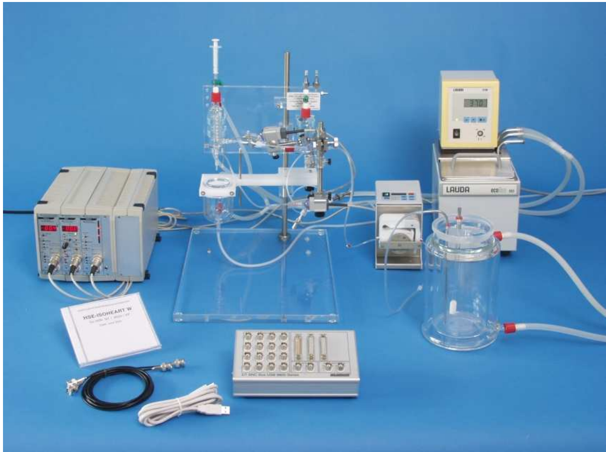
Obr. 29: Langendorffova aparatura. Převzato z [13].
