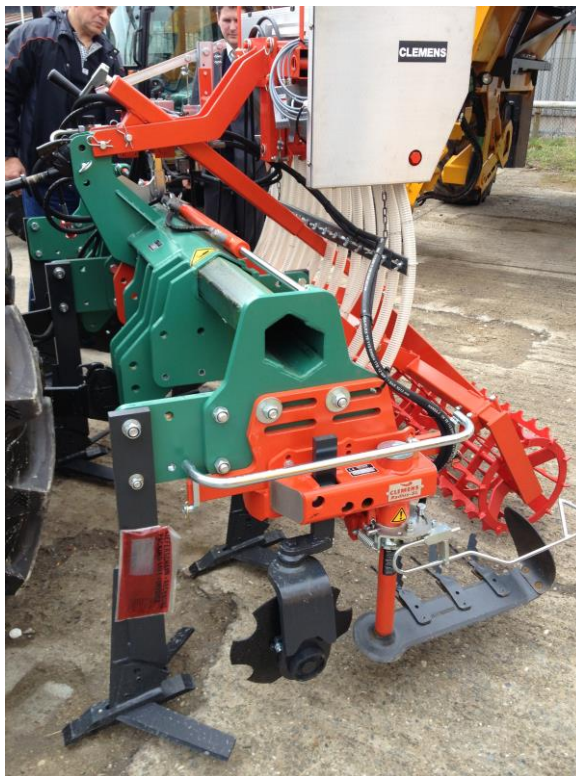
Obr.4: Hloubkové kypření s přihnojením a výklopnou sekcí od firmy Clemens
