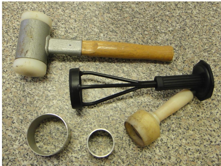
Obr.13: Nářadí pro odběr neporušeného půdního vzorku (VALLA, 2000)
