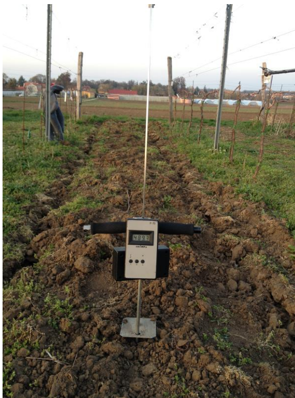
Obr.15: Penetrometr při měření P-70
