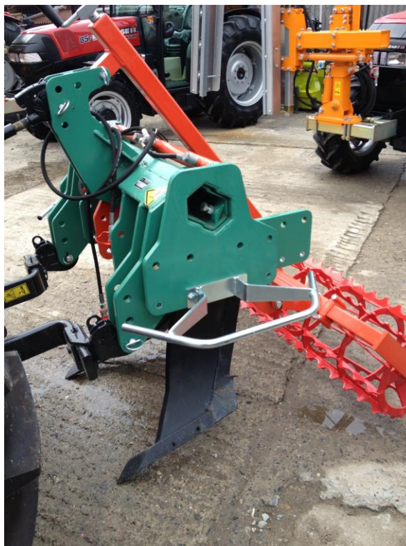
Obr.5: Nářadí od firmy Clemens s podrývacími slupicemi
