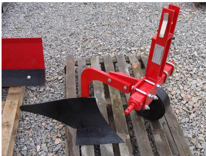
Obr.11: Pluh pro přiorání a odorání (HOUSER, 2015)
