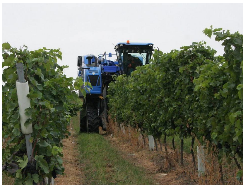
Obr.3: Multifunkční portálový nosič při sběru (ŠEVČÍK, 2011)
