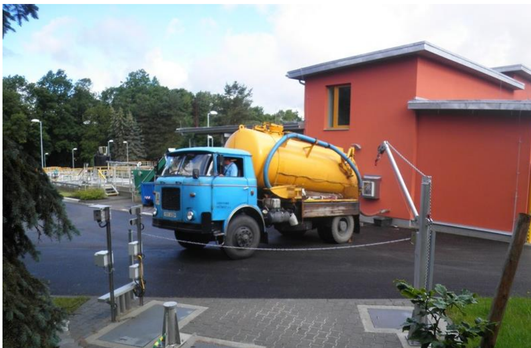
Obrázek 3 – Nákladní automobil Š-706 s cisternou o objemu 8 m 3 v ČOV Mnichovo Hradiště ( http://www.agpknezmost.cz/vyvazeni-septiku# )
