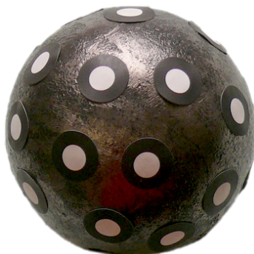
Obr. 8.2: Ocelová koule sloužící k ověření přesnosti metody měření momentu setrvačnosti.
