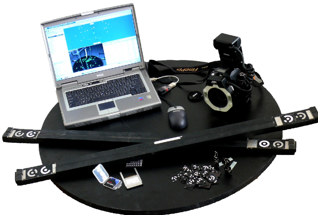
Obr. 4.1: Systém Tritop. Počítač, fotoaparát s bleskem, kalibrační tyče, sady kódovaných a nekódovaných bodů, paměťové médium.
