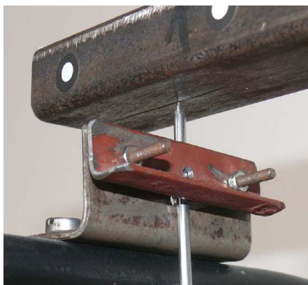
Obr. 7.2: Detail – ostrý hrot stojanu zapadá do drážky ve vodorovném rameni rámu.
