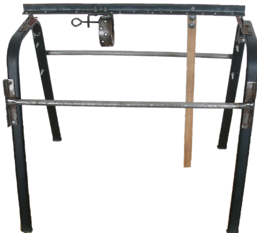
Obr. 7.4: Stojan a třetí verze rámu. Ve srovnání je upevněno měřené těleso, zde ocelové kolečko.
