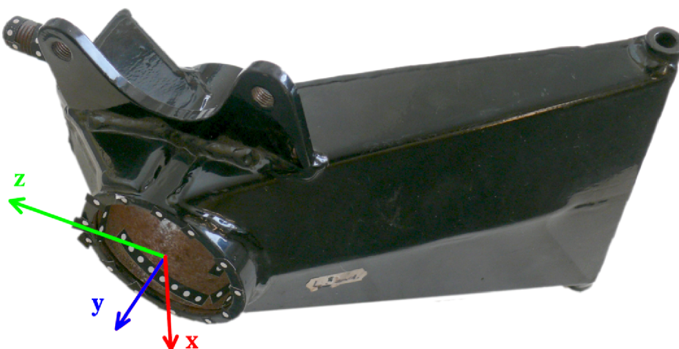
Obr. 5.3: Zadní těhlice formule Ford a souřadný systém.
