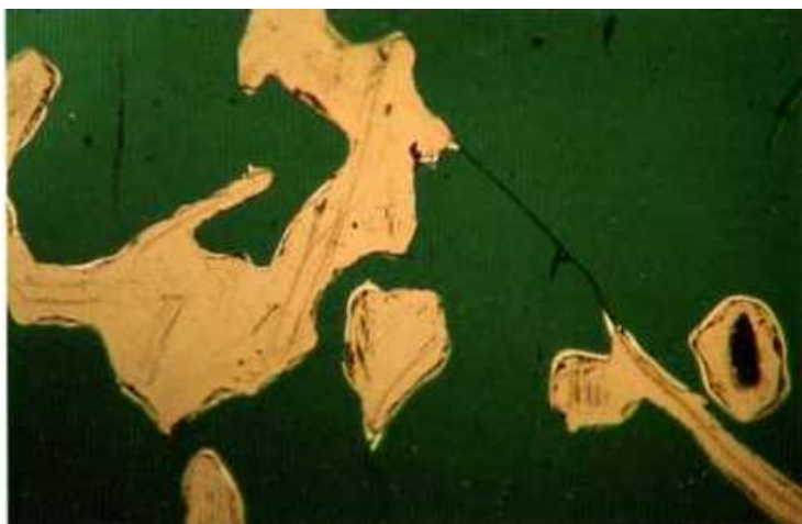
Obrázek 6-4: Loupání antireflexní vrstvy[28]
