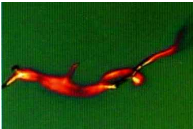
Obrázek 6-5: Vada způsobena prachovým vláknem ulpěným na povrchu čočky[28]
