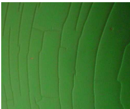
Obrázek 7-3: Popraskání antireflexní vrstvy vlivem přehřátí[27]
