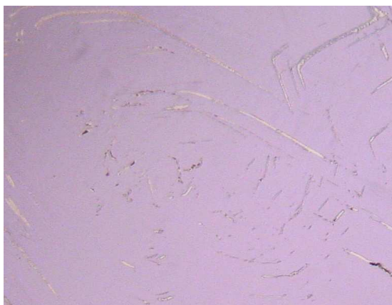
Obrázek 7-2: Při vyčištění brýlí nebo znečištěná přísavka při obrušování[27]
