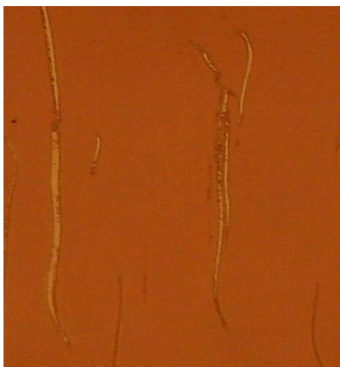
Obrázek 7-1: Škrábance způsobené částicemi nečistot[27]
