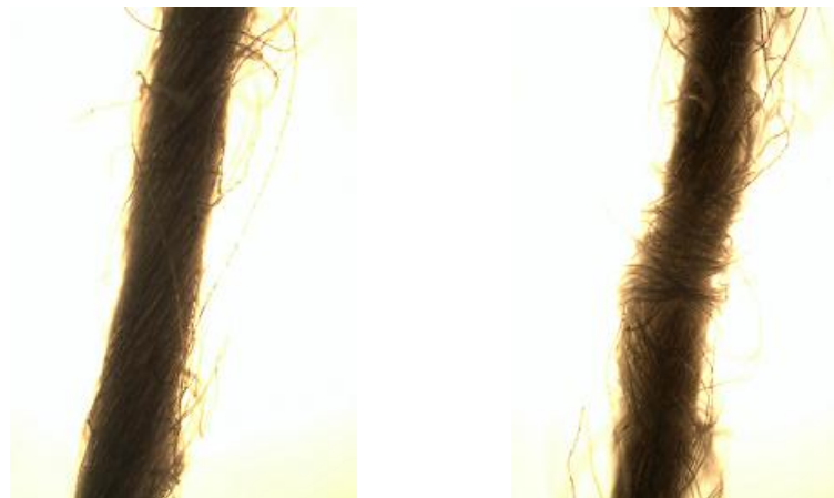
Obrázek 5- podélný pohled příze 100tex, am=85
