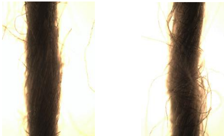
Obrázek 7- podélný pohled příze 150tex, am=75
