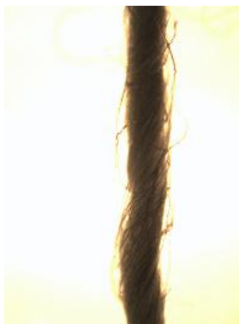
Obrázek 3- podélný pohled příze 60tex, am=95
