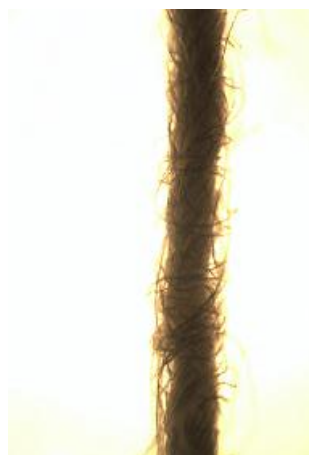
Obrázek 3- podélný pohled příze 60tex, am=95
