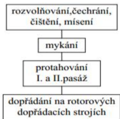
Obr. 1 Postup výroby rotorové příze [4]
