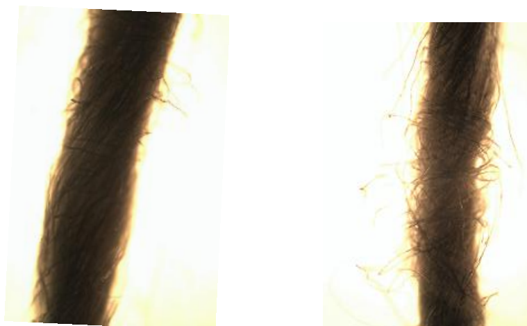
Obrázek 9- podélný pohled příze 150tex, am=95
