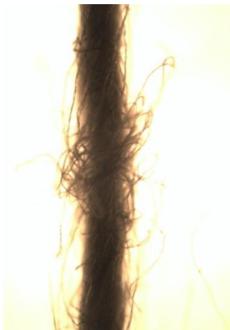
Obrázek 1- podélný pohled příze 60tex, am=75
