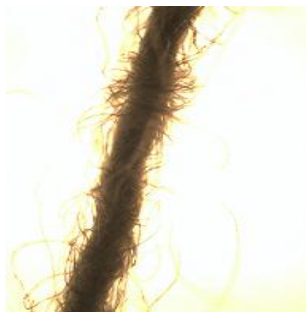
Obrázek 2- podélný pohled příze 60tex, am=85
