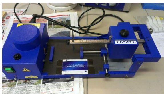
Obr. 40 Odolnost vůči vrypu (Z knihovny autora)
