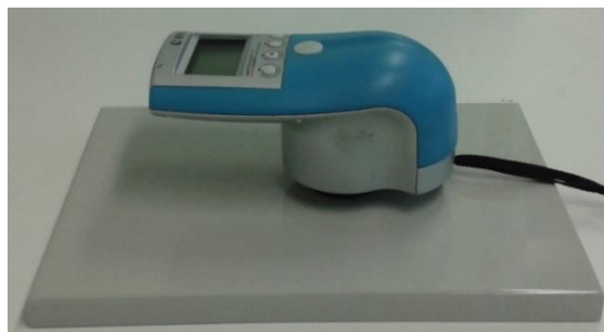
Obr. 35 Stanovení barevnosti spektrofotometrem (Z knihovny autora)
