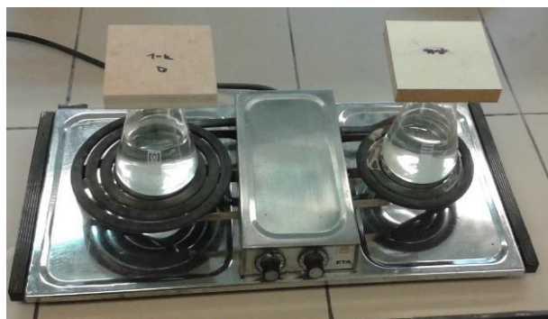
Obr. 39 Stanovení odolnosti proti působení vodní páry (Z knihovny autora)
