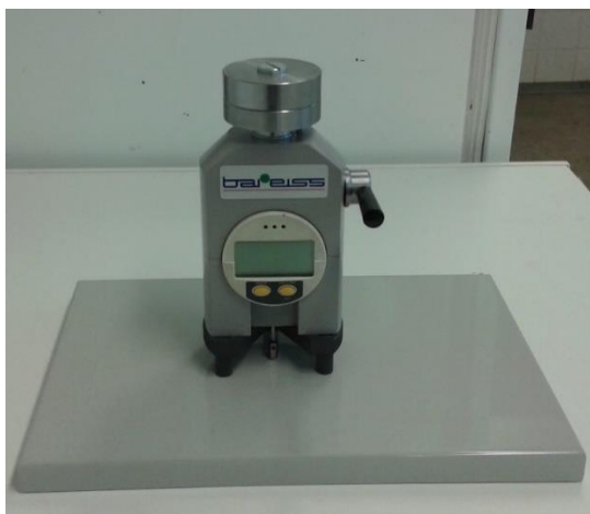
Obr. 37 Stanovení odporu vůči vnikání mikrotvrdoměru (Z knihovny autora)
