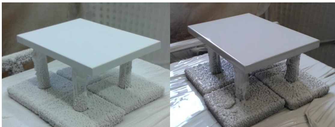
Obr. 31 Dílec po nástřiku základní barvy a laku (vlevo) a vrchní barvy (vpravo) (Z knihovny autora)
