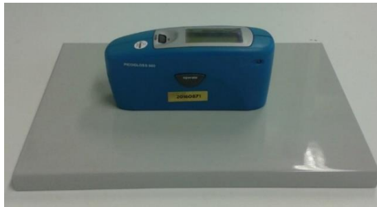
Obr. 34 Stanovení stupně lesku povrchu (Z knihovny autora)
