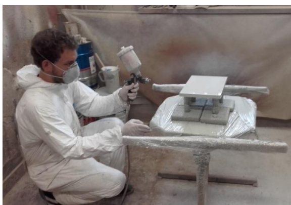
Obr. 32 Stříkání vrchní barvy – použití speciálního obleku pro zajištění bezprašných podmínek (Z knihovny autora)
