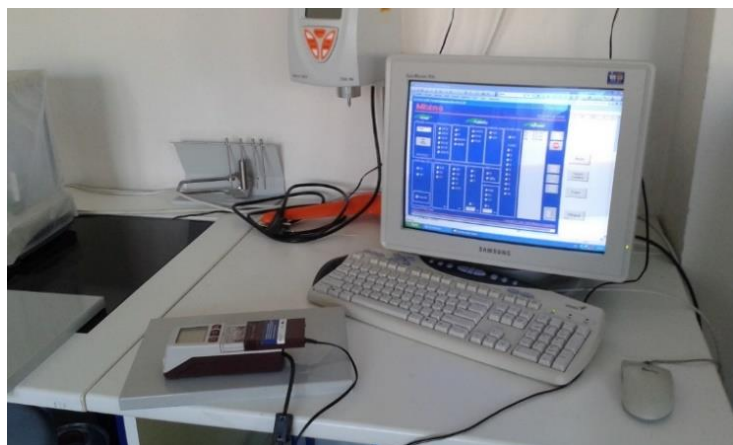
Obr. 38 Stanovení drsnosti drsnoměrem (Z knihovny autora)
