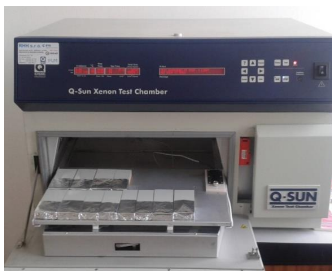
Obr. 41 Zjišťování světlostálosti povrchu (Z knihovny autora)
