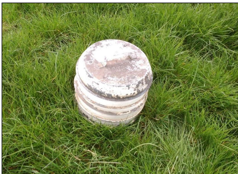
Obr. 3 Elektronický registrátor HOBO umístěný v plastovém krytu (GRYDZHUK, 2016)
