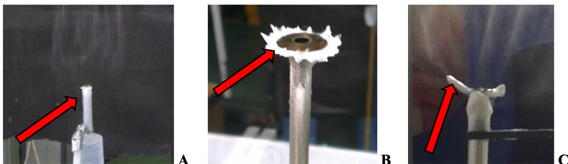
Obrázek 8: Příklady tvorby sušiny na zvláknovacích elektrodách [7]
