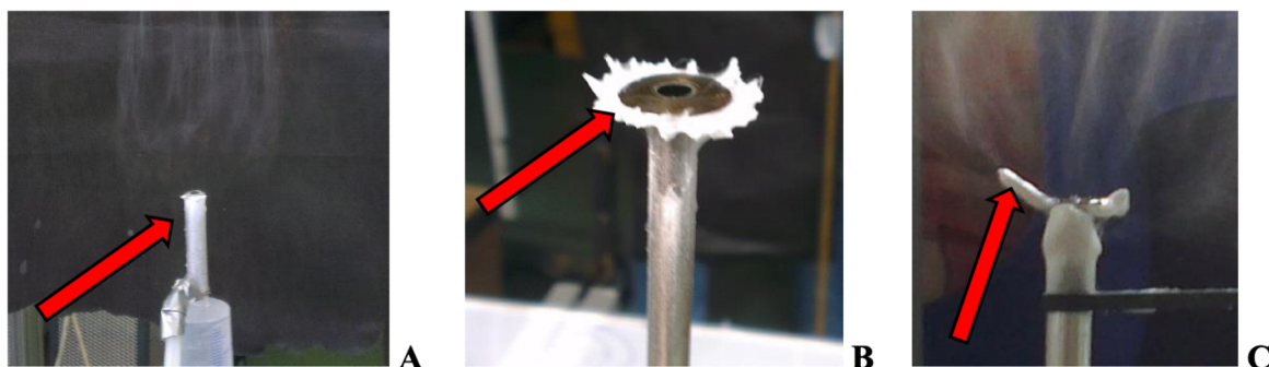
Obrázek 8: Příklady tvorby sušiny na zvláknovacích elektrodách [7]
