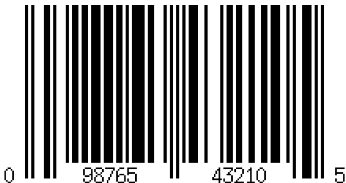
Obr. 1.2 Zobrazení U.P.C. A
