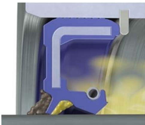
Obr. 2.16 Těsnění hřídele pomocí gufera s prachovkou [x106]
