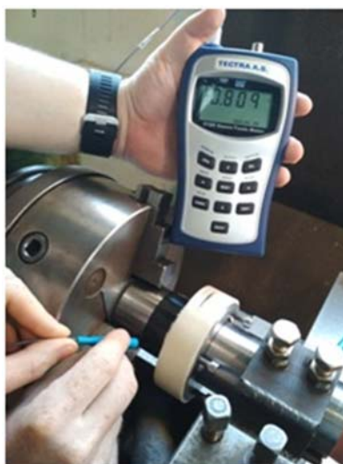
Obr. 5.5 Měření indukce po obvodu vnější mezery mezi pólovým diskem a rotorem na finální verzi ucpávky (varianta 2)
