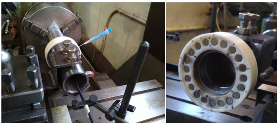
Obr. 6.2 Detail upnutí ucpávky do opěrky soustruhu ( vlevo ), nabitá matrice magnetů ( vpravo )
