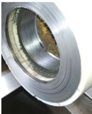
Obr. 6.5 MR kapalina v místě spáry po odpaření určitého množství nosné látky
