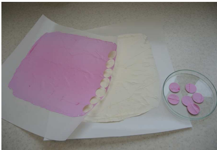
Obrázek 11: Fotografie připravených nanovláčkových vrstev s obsahem erytrozinu a s obsahem riboflavinu. Na Petriho misce se nachází vzorky nanovláčkové vrstvy s obsahem erytrozinu nastříhané pomocí kruhových nůžek.
