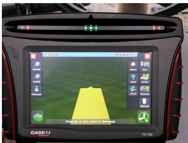
Obrázek 9 LCD obrazovka spojená s LED diodovou naváděcí lištou [21]
