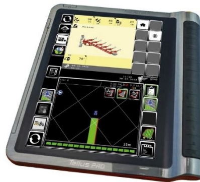
Obrázek 17 IsoMatch Tellus PRO obrazovka s duální funkcí sledování dvou procesů [5]
