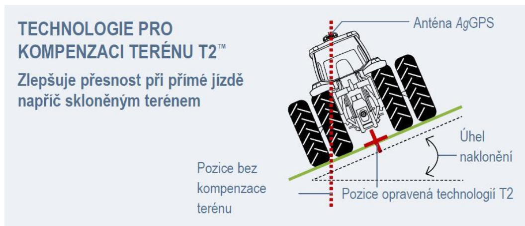
Obrázek 14 Vychýlení polohy GPS přijímače na svahu [21]
