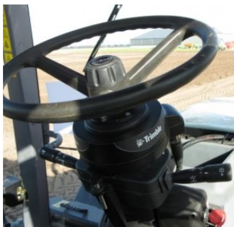
Obrázek 11 Výměnný volant se zabudovaným elektromotorem [23]
