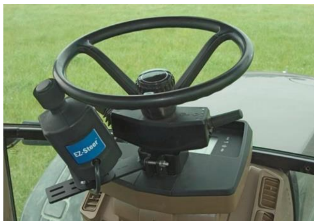
Obrázek 10 Elektromotor pro ovládání volantu [22]
