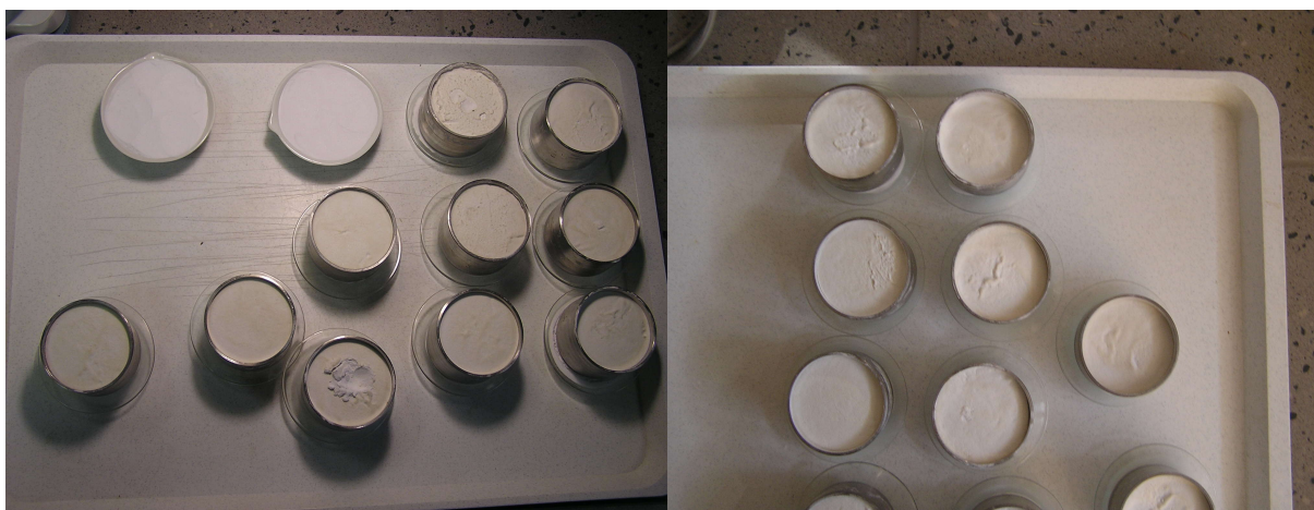
Obr. 15 Vzorky syntetického písku po měření K_s 1. série (vlevo) a 2. série (vpravo).
