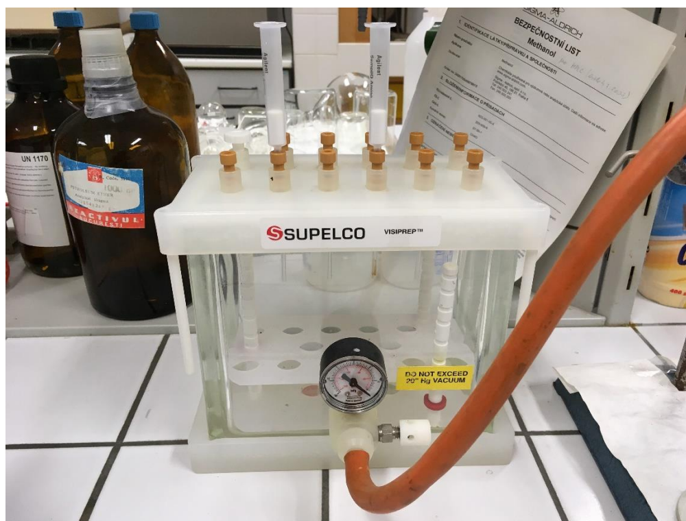
Obrázek 11: Zařízení SPE Manifold s \text{NH}_2 -kolonkami.
