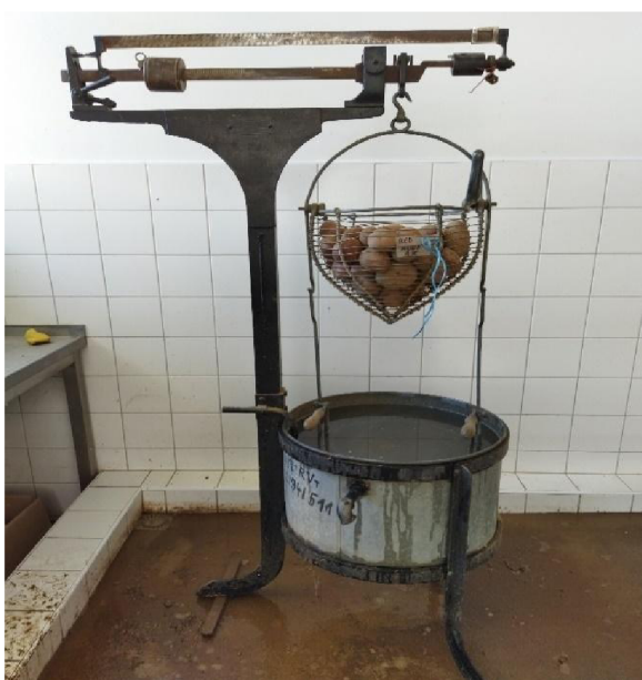
Obrázek 7: Měření škrobu na Hošpes - Pecoldově váze
