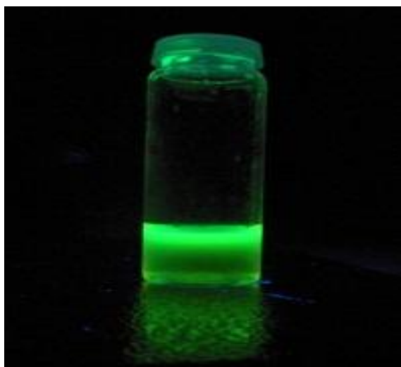
Obr. 12 Pripravené vo vode rozpustné CdTe QDs stabilizované glutathionom, vľavo sú QDs pod UV lampu, vpravo QDs na dennom svetle
