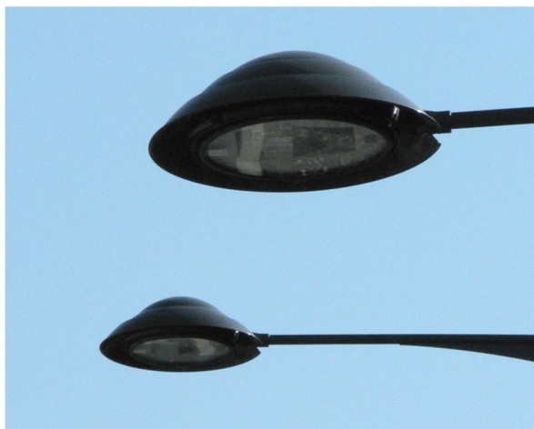
(10) Ulice Na střelnici (49.5989672N, 17.2513061E) Nejvhodnější svítidlo – plochý difuzor, který směřuje nepříliš jasné světlo rovnou pod sebe
