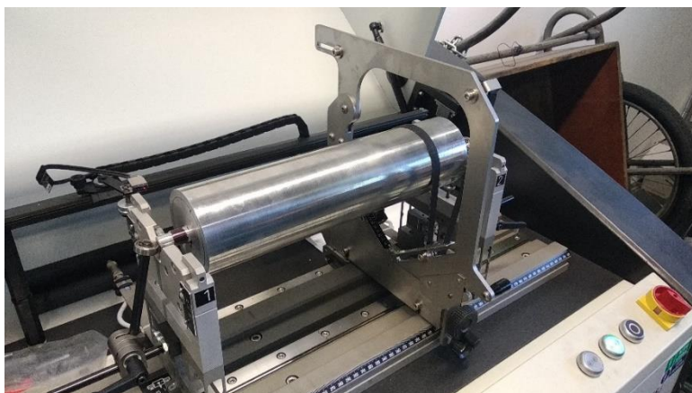
Obrázek 33: Vyvažování opěrného válce
