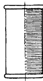
Obrázek 3: Rovnoběžné vinutí s čelem jištěným přírubou [2]
