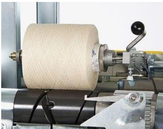
Obrázek 8: Navíjení cívky pomocí rozváděcího válečku [5]
