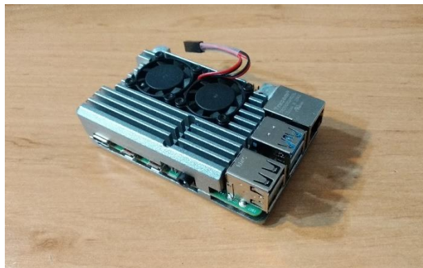
Obrázek 39: Raspberry Pi s namontovaným chladičem
