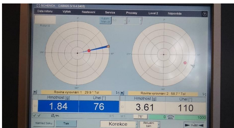
Obrázek 34: Nevýváženost opěrného válce
