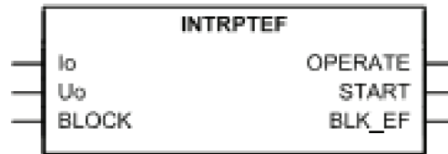
Obrázek 3.10 Blok ochrany INTRPTEF převzato z [2]
