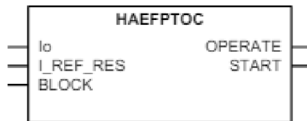
Obrázek 3.7 Blok ochrany HAEFPTOC převzato z [2]
