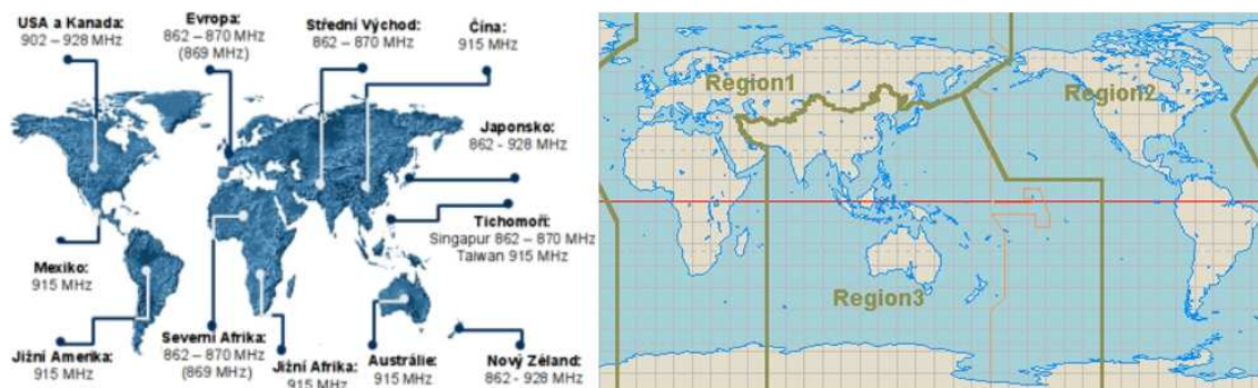
Obrázek 8 Pásma pro RFID typu UHF [15]
