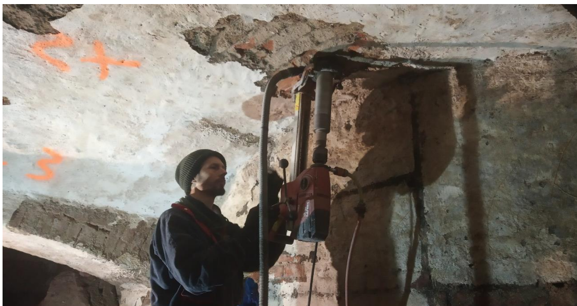
Obrázek 25, Probíhající odebrání vzorku z klenby pomocí jádrové vrtačky (vrt V4) [18].
