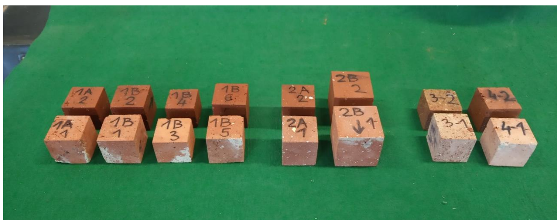
Obrázek 27, Sady reprezentativních těles na zkoušku pevnosti v tlaku; horní řada – nasycené, dolní řada – vysušené [18].
