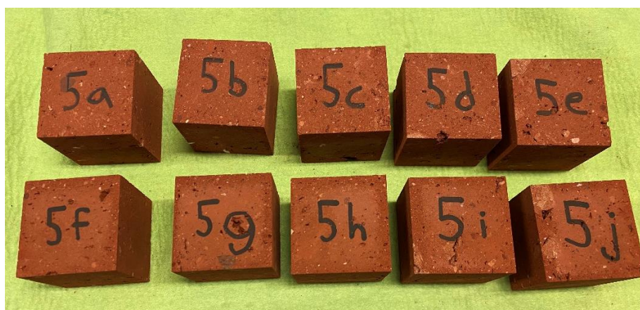
Obrázek 39, Zkušební vzorky cihly č. 5.
