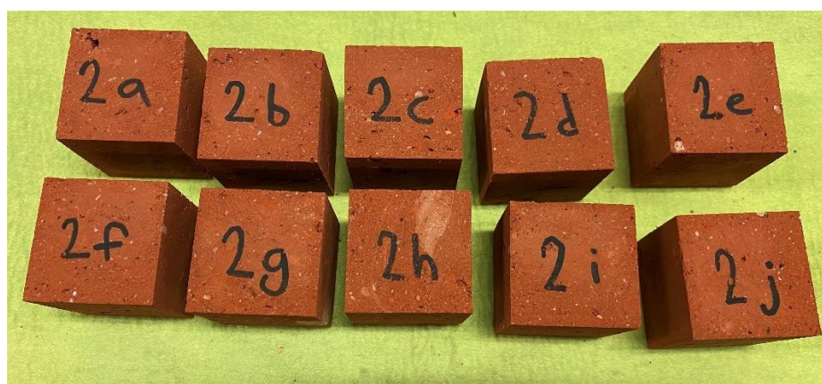
Obrázek 36, Zkušební vzorky cihly č. 2.
