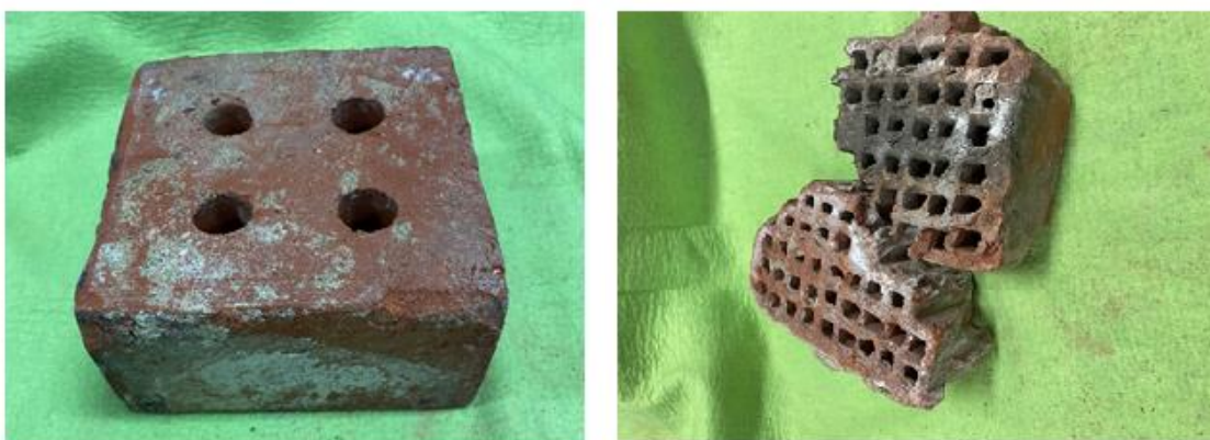
Obrázek 34, Ukázka dutinových cihel nalezených ve sklepních prostorech.
