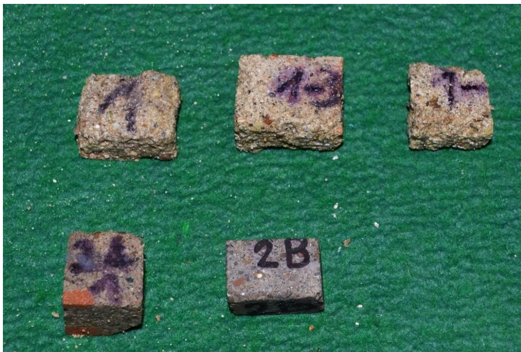
Obrázek 33, Zkušební tělesa malých rozměrů z malty odebrané pomocí jádrového vývrtu [18].
