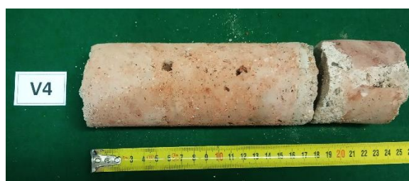
Obrázek 26, Soubor vzorků z jádrových vývrtů V1-V4 [18].
