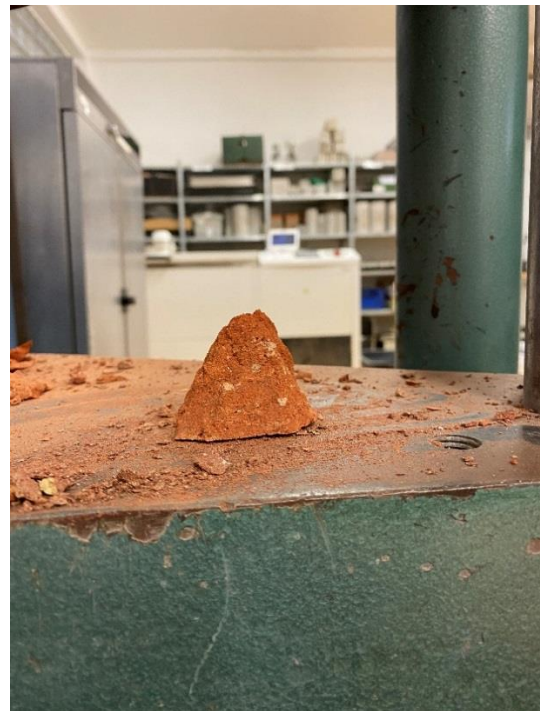
Obrázek 45, Průběh zatěžovací zkoušky v lisu; 1. obrázek - uchycení tělesa v lisu, 2. obrázek - těleso těsně po zatěžovací zkoušce, 3. obrázek - první možnost porušení „přesýpací hodiny“, 4. obrázek – druhá možnost porušení „klín“.
