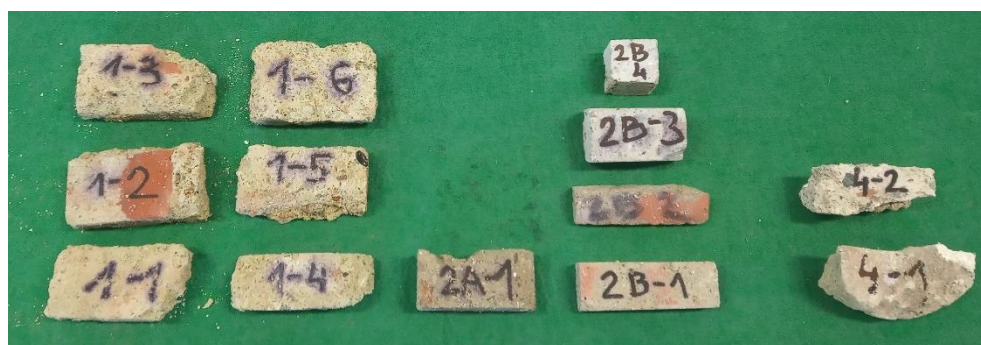
Obrázek 31, Zkušební vzorky malty odebrané pomocí jádrových vývrtů [18].
