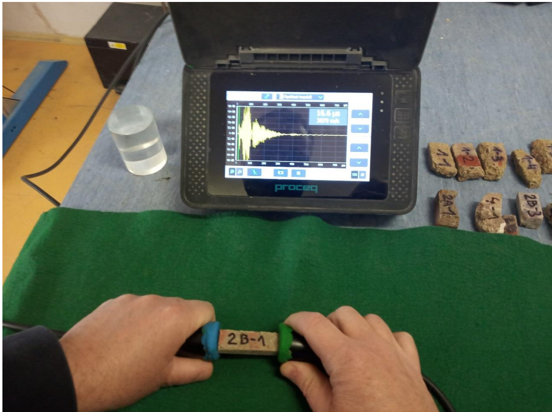
Obrázek 32, Ukázka měření rychlosti šíření ultrazvuku na vzorcích malty z konstrukce [18].
