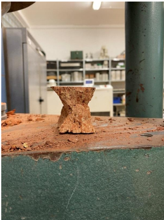
Obrázek 45, Průběh zatěžovací zkoušky v lisu; 1. obrázek - uchycení tělesa v lisu, 2. obrázek - těleso těsně po zatěžovací zkoušce, 3. obrázek - první možnost porušení „přesýpací hodiny“, 4. obrázek – druhá možnost porušení „klín“.
