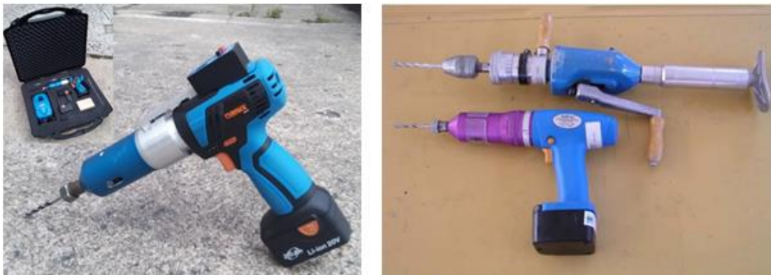
Obrázek 6, Nalevo - upravená elektrická vrtačka KV-3, napravo - Kučerova vrtačka a elektrická PZZ 01 [2], [21].
