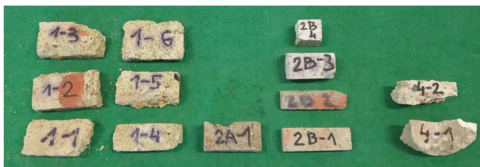
Obrázek 31, Zkušební vzorky malty odebrané pomocí jádrových vývrtů [18].
