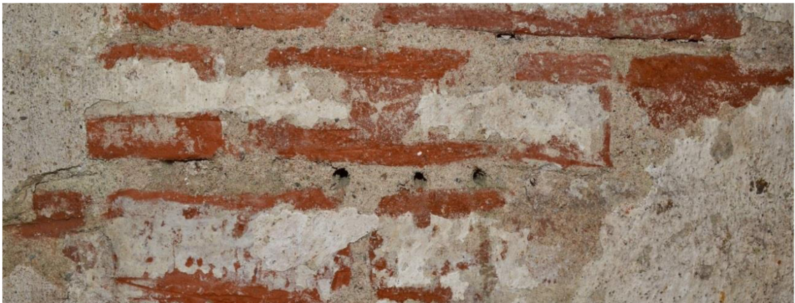
Obrázek 30, Ukázka zkušebního místa pro zjištění pevnosti malty Kučerovou vrtačkou [18].
