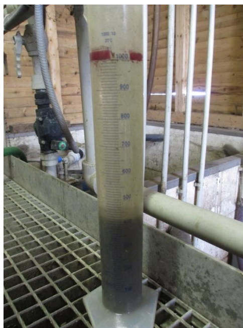
Obr. 2 Aktivační čistírna A: Usazování kalu ve vzorku o objemu 1 l
