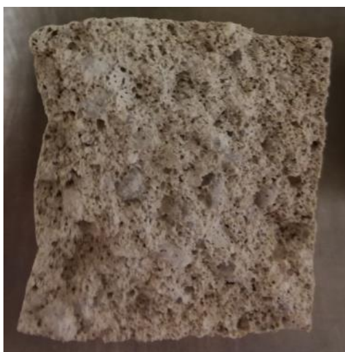
Obr. 21: Snímek vzorku č. 27 po měření pevnosti v tahu za ohybu
