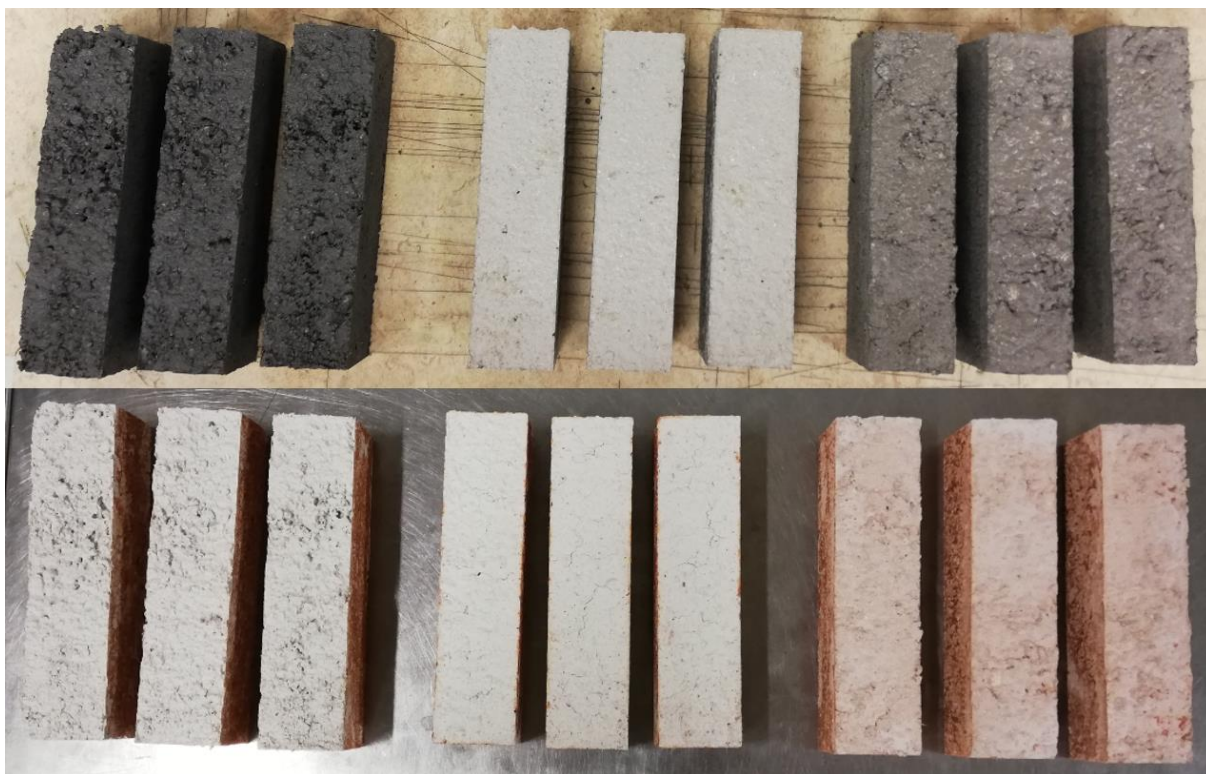
Obr. 10: Vzorke žárobetonů po odformování (horní řada) a po výpalu (spodní řada)
