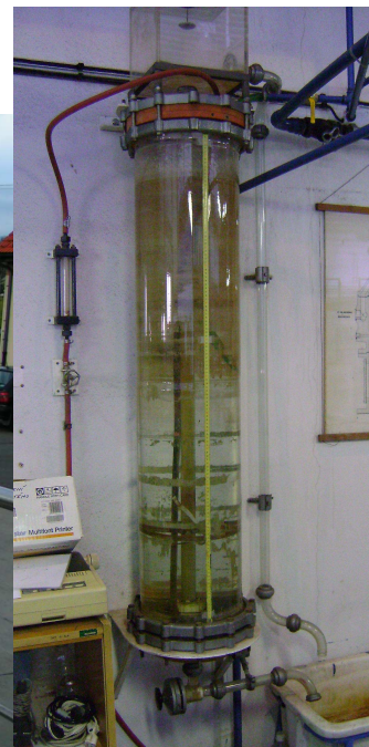
Obr. 2.3 Mamutové čerpadlo na VUT Ústavu fluidního inženýrství Viktora Kaplana
