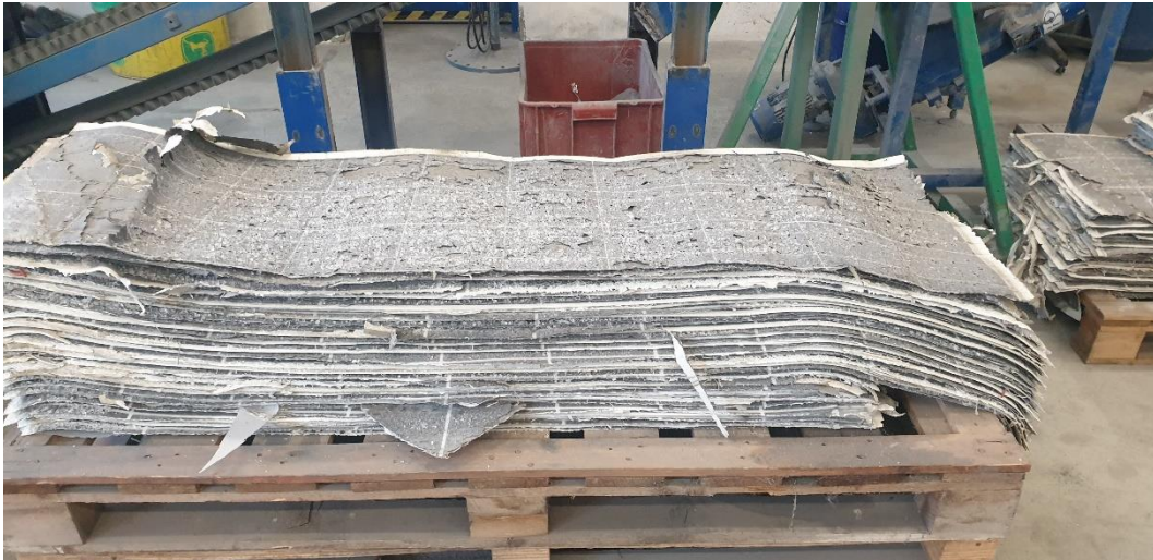
Obrázek 13 Polovina FV panelů po odstranění skleněné vrstvy
