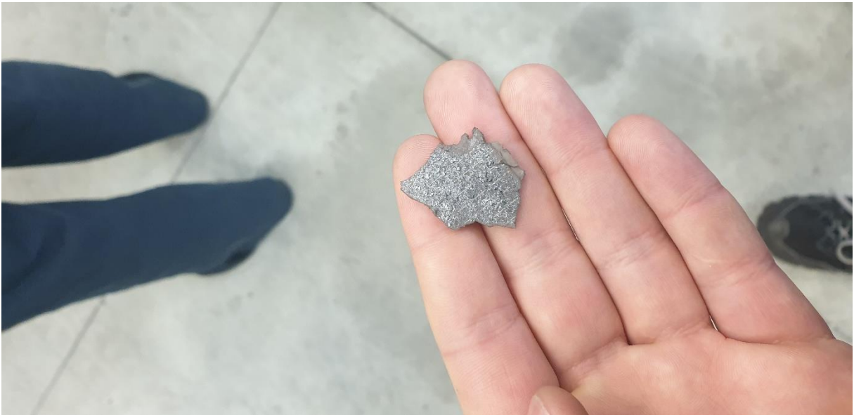
Obrázek 16 Výsledný produkt po mechanické metodě zpracování FV panelů
