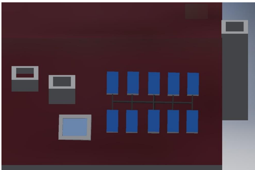
Obrázek 8 Detail uložení panelů na střechu rodinného domu
