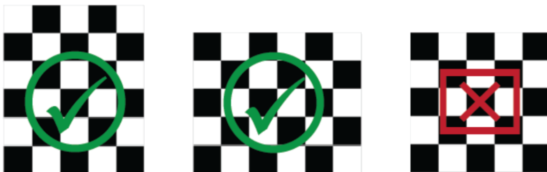
Obr. 5 Správny kalibračný vzor (prevzaté z [9])
