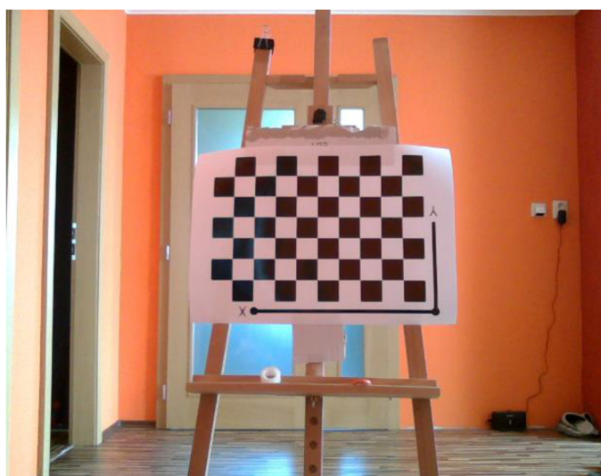
Obr. 27 Kalibračná scéna na testy v reálnom svete
