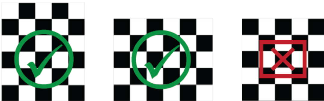
Obr. 5 Správny kalibračný vzor (prevzaté z [9])
