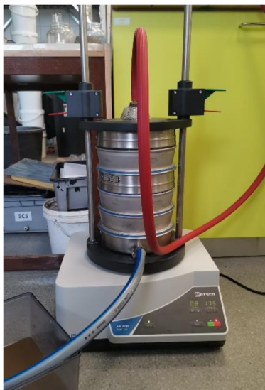
Obr. 14: Prosévání mokrou cestou na laboratorní prosévačce Retsch AS 200 digit cA
