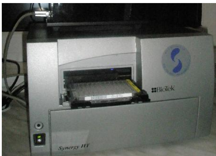
Obr. 19: Synergy HT reader s vloženou mikrotitrační destičkou.
