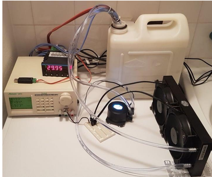
Obr. 4-2: Foto z průběhu měření tepelného odporu výměníku
