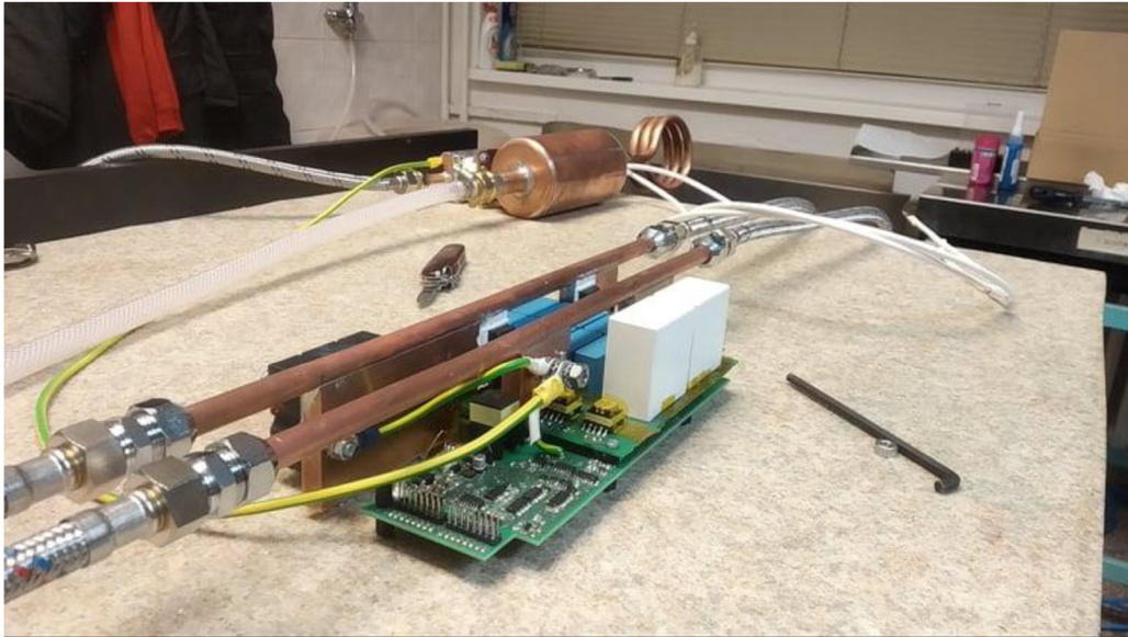
Obr. 6-4: Foto z průběhu ožívování invertoru
