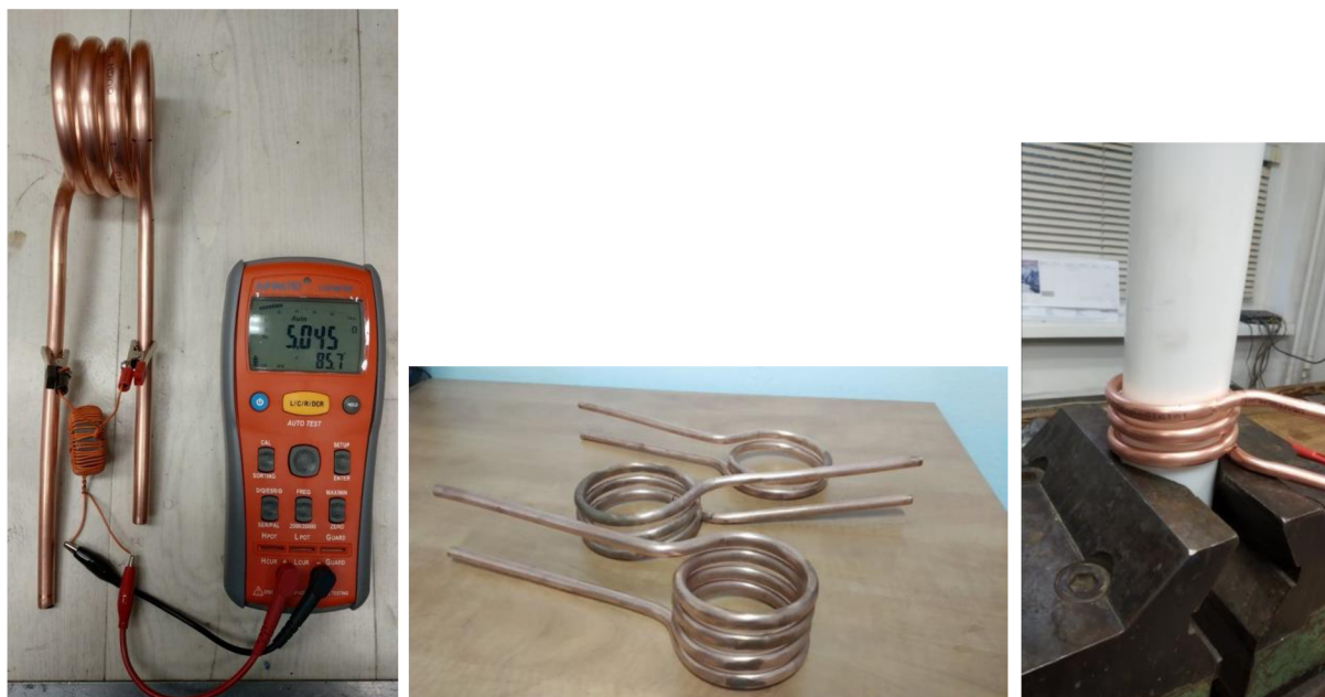
Obr. 3-6: Foto z průběhu měření a tvorby induktorů
