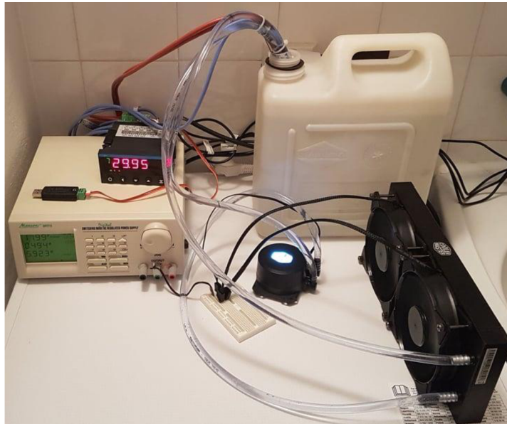
Obr. 4-2: Foto z průběhu měření tepelného odporu výměníku
