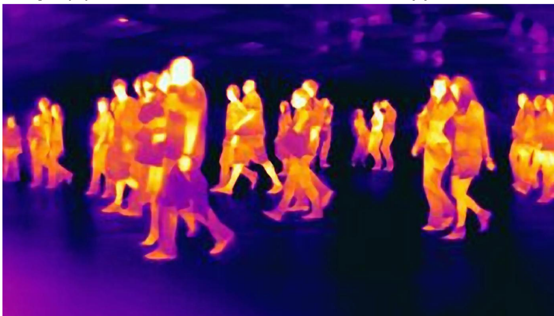
Obrázek 11 Detekce osob pomocí infrazkamery [17]
