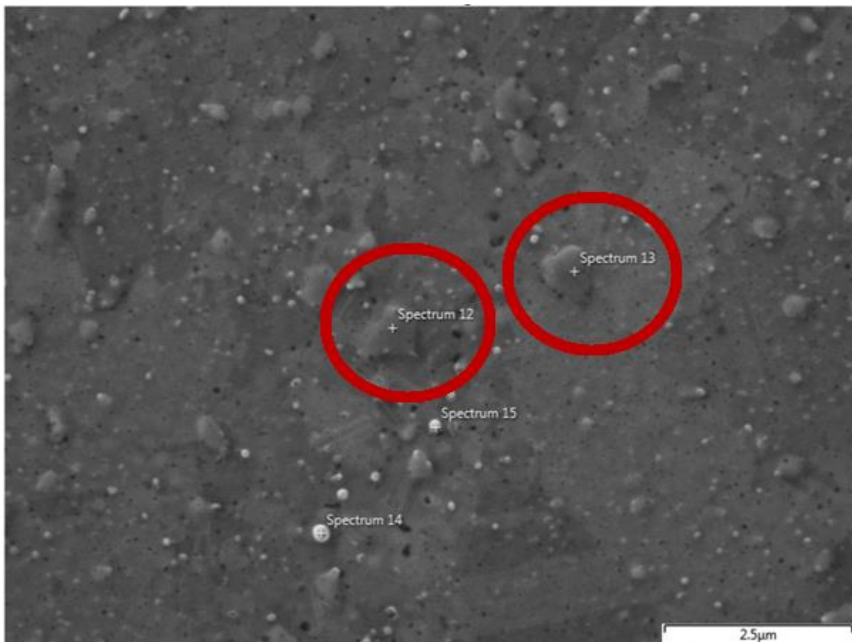
Obr. 11.15: Struktura CoCrFeNi po 30 h mletí v Ar (vzorek HEA-Ar-30) a SPS s vyznačenými oblastmi bodové EDS analýzy.
