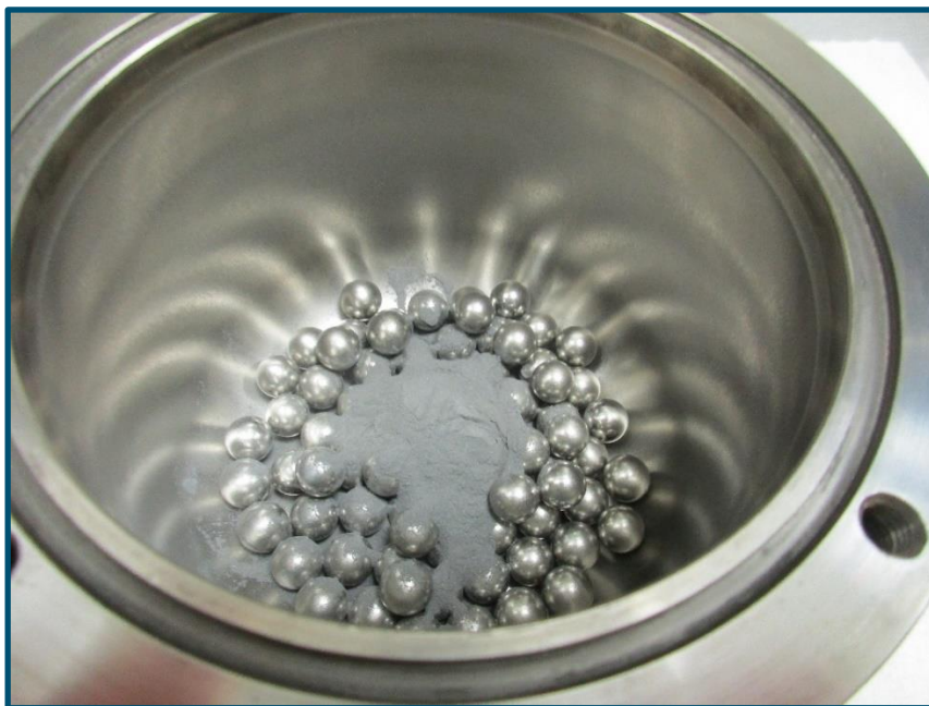
Obr. 1.1: Zpracováváný prášek, který je společně s mlecími elementy umístěn v mlecí misce.
