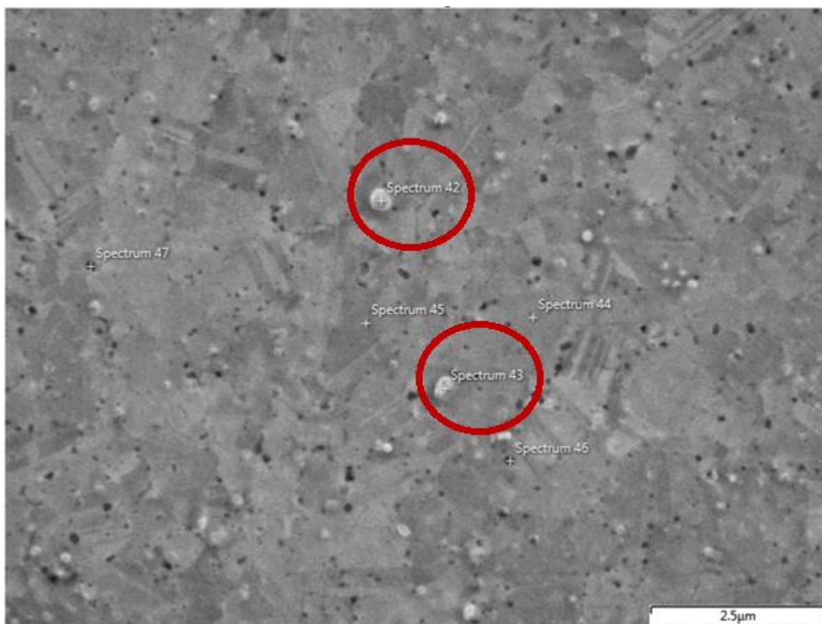
Obr. 11.12: Struktura CoCrFeNi HEA po 5 h mletí v \text{N}_2 (vzorek HEA-N-5) a SPS s vyznačenými oblastmi bodové analýzy chemického složení pomocí EDS.
