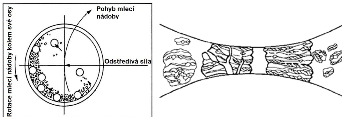
Obr. 3.1: (Vlevo) Schéma sil působících na mlecí elementy v planetárním kulovém mlýnu. (převzato a upraveno z [2]); (Vpravo) Schéma deformací práškových částic při srážce mlecích elementů. (převzato a upraveno z [3])
