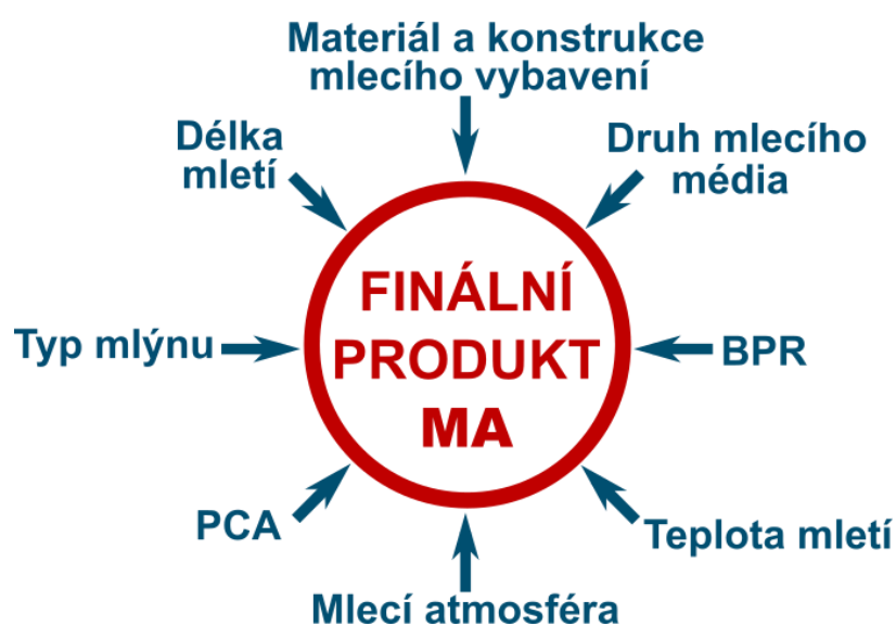
Obr. 3.3: Schéma hlavních procesních parametrů, ovlivňujících vlastnosti finálního produktu mechanického legování. (převzato a upraveno z [2])
