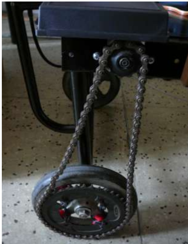
Obr. 2.15 Prevod ozubenými kolesami a v krabičke ukrytá elektronika.
