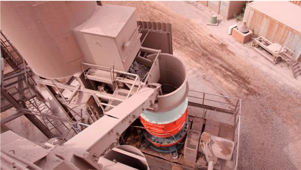
Obr. 53 Kuželový tupouhlý drtič CH660 při sekundárním drcení kameniva [77]
