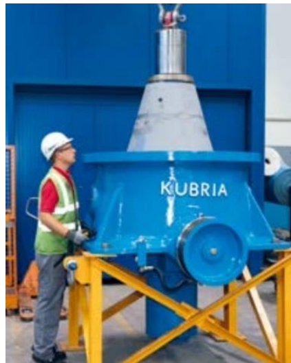
Obr. 44 Výměna drticích elementů [34]
