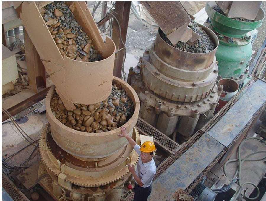
Obr. 43 MSP 400 kuželový drtič při sekundárním drcení v Taiwanu [51]
