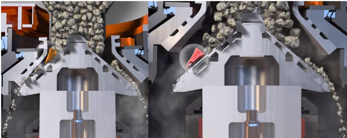
Obr. 16 Uvolnění nedrtitelného materiálu z drticí komory u jednoválcového hydraulického kuželového drtiče [91]
