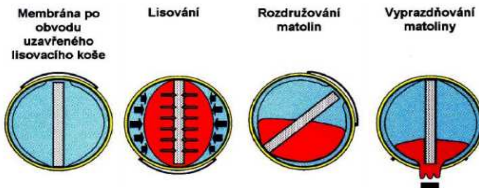
Příloha 5 Uzavřený lis s membránou uchycenou na polovině vnitřní strany (Burg, Zemánek, 2011)
