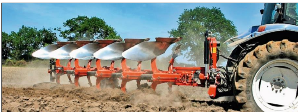
Obr. 7 – Příklad orby oboustranným pětiradličným pluhem (Paulová, 2013; upraveno)
