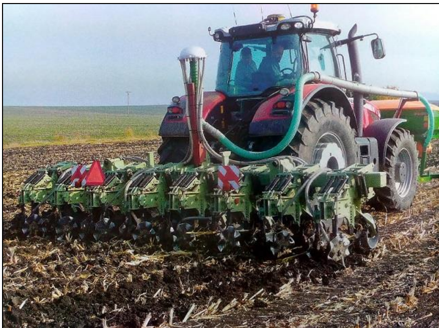
Obr. 8 – Stroj na zpracování půdy do pásů (Šebela, 2015)
