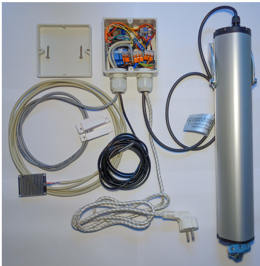
Obrázek 4.2: Kompletní komponenta pro ovládání střešního okna. Instalační krabice, dešťový senzor, magnetický senzor/spínač, teplotní čidlo DS18B20, přívodní napájecí kabel a motor pro manipulaci s oknem.
