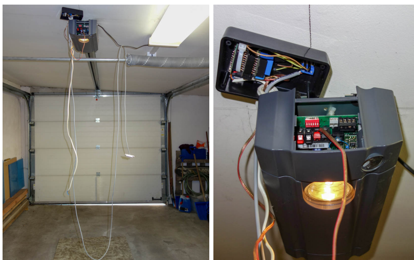
Obrázek 4.9: Ukázka z testování komponenty. Na obrázku je vidět komponenta připojená na svorky současného systému. Vyobrazená komponenta obsahuje zatím ještě Power Shield.
