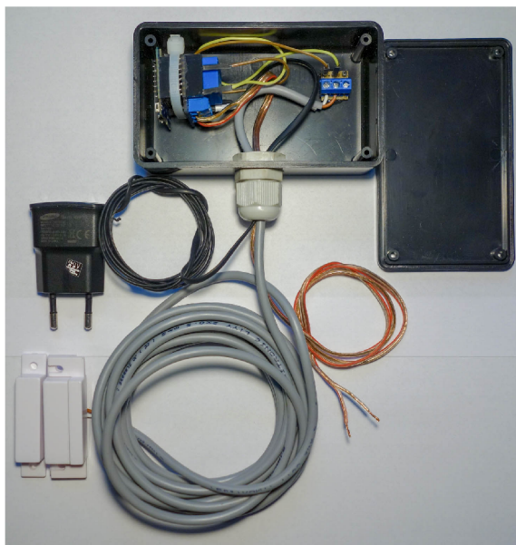
Obrázek 4.7: Zkonstruované zařízení pro ovládání garážových vrat. Deska WEMOS a na ní nasazený spínač v podobě relé. Dále DPS připojená na piny desky WEMOS , kde na plošném spoji je vidět připájená svorkovnice a do ní připojený magnetický senzor.
