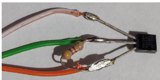
Obrázek 4.11: Upravené teplotní čidlo DS18B20. DS18B20, připájený 4,7 k \Omega pull-up rezistor mezi datový pin 2 a kladný pól napájení, dále tři vodiče pro připojení k desce WEMOS .
