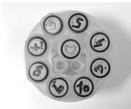
Obrázek 17: Fantom pro statické měření relaxačních časů T1
