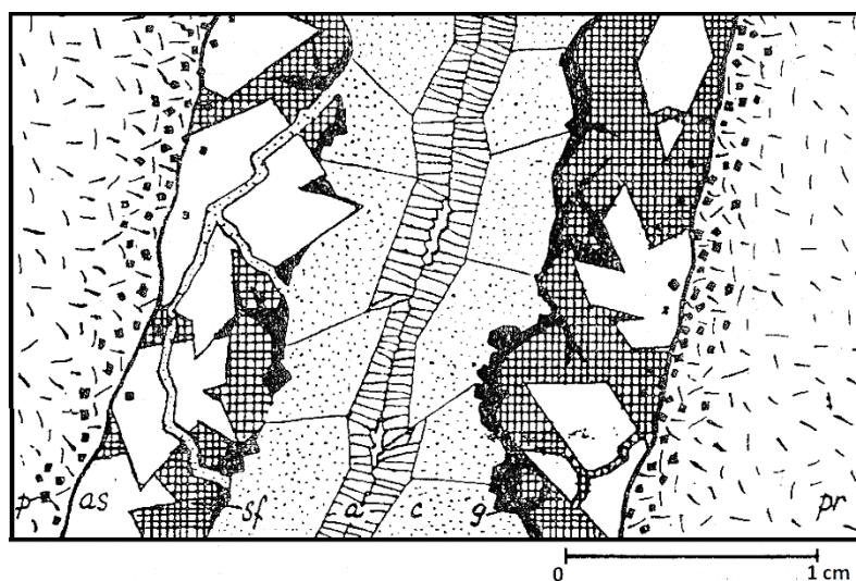
Obr. 6 Zonální výplň rudní žíly (Černý 1958) pr – propylit, p – pyrit, as – arsenopyrit, sf – sfalerit, c – kalcit, a – ankerit, g – galenit a chalkopyrit
