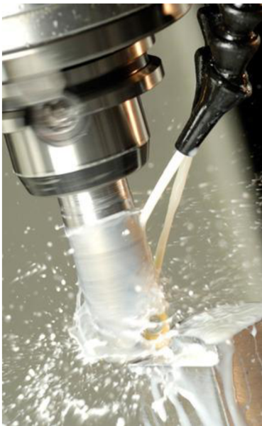
Obr. 6 Aplikace emulze při frézování [8].
