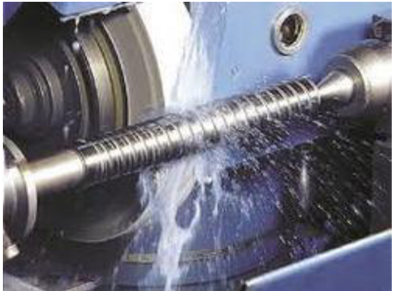
Obr. 7 Aplikace syntetické kapaliny při broušení rotační součásti [9].
