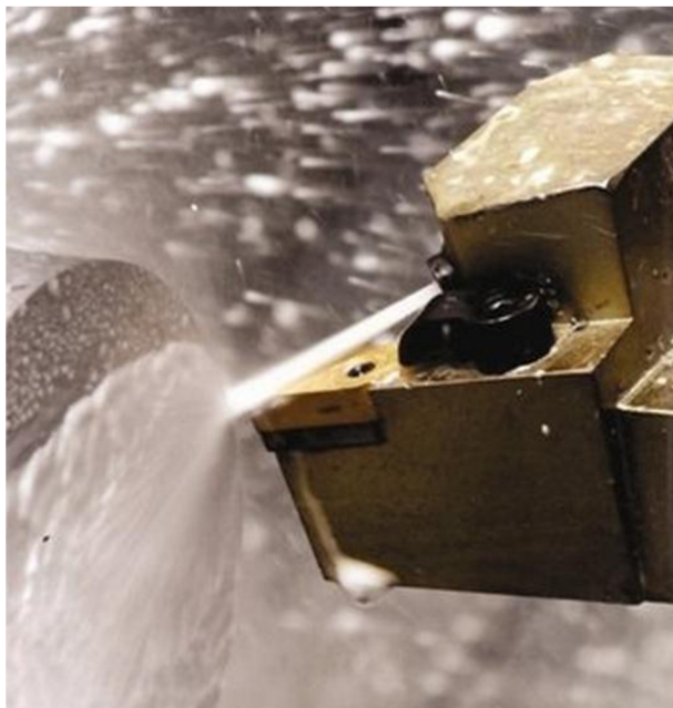
Obr. 16 Vysokotlaké chlazení soustružnického nástroje [19].
