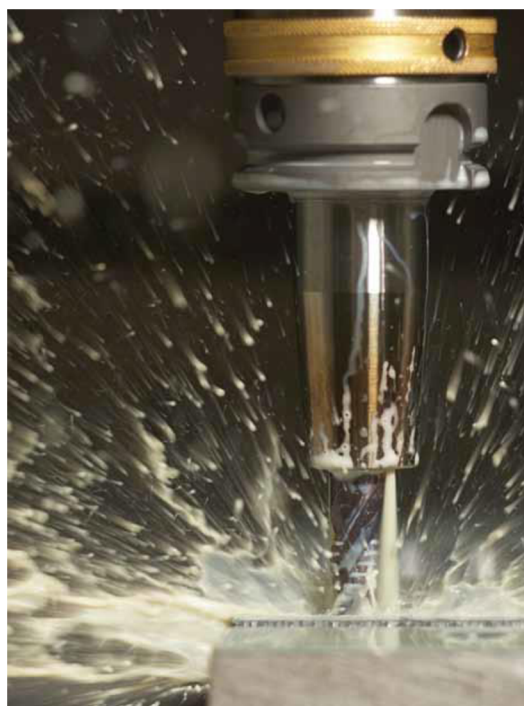
Obr. 15 Aplikace periferního chlazení při frézování [16].
