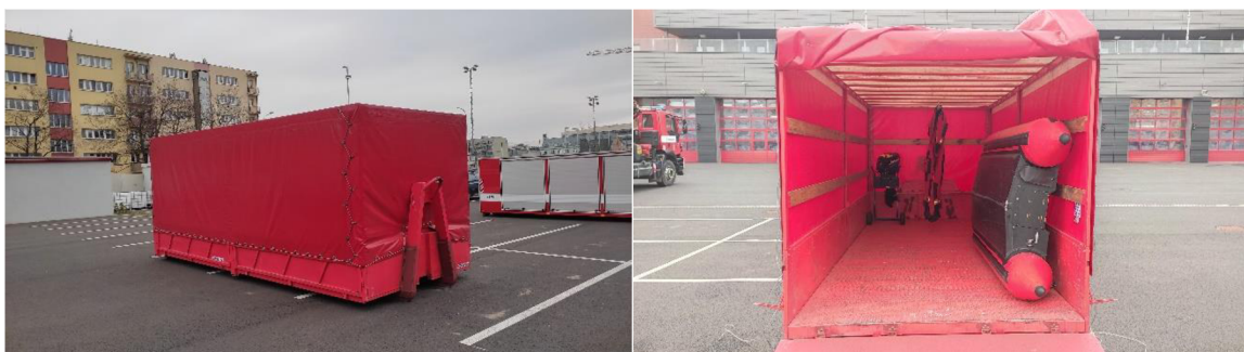
Obrázek č. 11.: Kontejner Vana plechová s plachtou s vybavením
