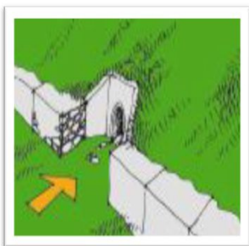
a) Trubní propust
