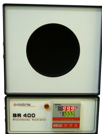
Obr. 3.2: Komerčne dostupné čierne teleso na kalibráciu termokamier. 1
