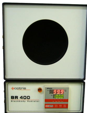
Obr. 3.2: Komerčne dostupné čierne teleso na kalibráciu termokamier. 1
